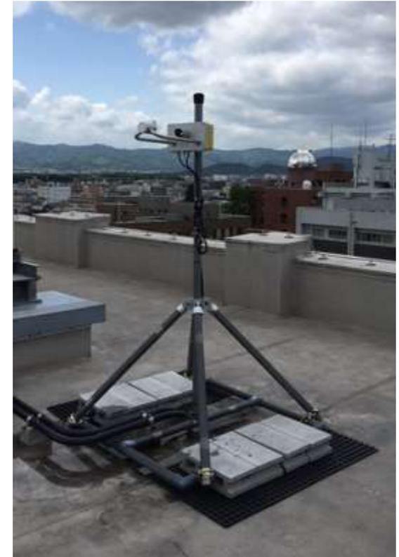
理学部1号館屋上設置のレーザ式降水粒径速度分布測定装置
