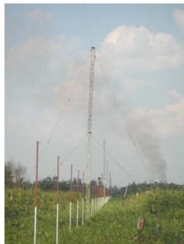
図 9 Pontianak に設置した長大な半波長アンテナアレイの一部。高さ 10m の鉄塔の間にアンテナ（銅線）を張り、その中間にバランを設置。下部の赤白ポールは信号ケーブル敷設用で、水没および鼠害を防ぐ。
